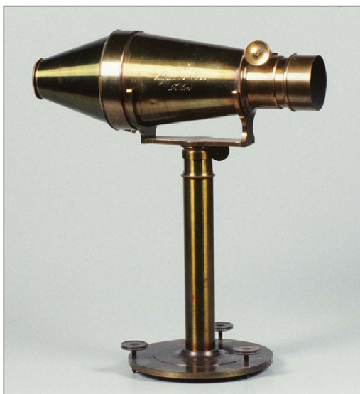
Obr. 2. Daguerrotypický fotografický přístroj Voigtländer, výrobek stejnojmenné vídeňské firmy z roku 1841. Jednalo se o první daguerrotypický celokovový fotoaparát (Ganzmetallkamera). Replika zhotovená v roce 1956, kdy bylo vyrobeno 200 kamer k 200. výročí společnosti Voigtländer. Zdroj: https://web.archive.org/web/20110611081050/http://www.geh.org/fm/mees/htmlsrc/mV89100002_ful.html#topofimage
