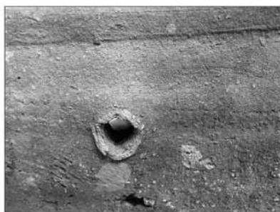
Obr. 5. Litovel, městská část Chořelice, výrobní vady na vybraných kachlích. Foto: L. Hlubek.
