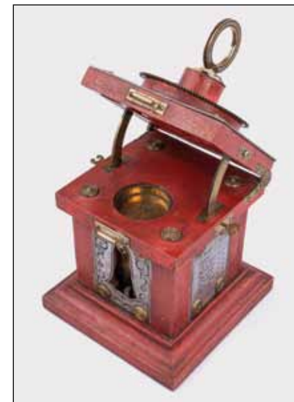
Obr. 2. Jan Michael Faselli, Přenosné sluneční univerzální mechanické rovníkové hodiny s minutovým číselníkem, 1733, Vlastivědné muzeum v Olomouci. Foto: Martin Šilar. Na snímku je patrný kompas vsazený do horní vodorovné desky schránky a dvě destičky, přední se zvonovitým vykrojením výřezu pro zavěšení olovnice a boční s názvy osmi evropských měst s uvedením souřadnic zeměpisné šířky v stupních.
