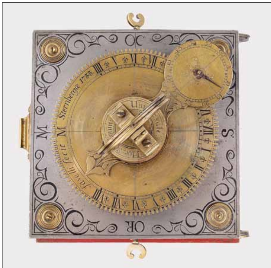
Obr. 3. Jan Michael Faselli, Přenosné sluneční univerzální mechanické rovníkové hodiny s minutovým číselníkem, 1733, Vlastivědné muzeum v Olomouci. Foto: Martin Šilar. Detail horní sklopné desky s hlavním hodinovým a přidávným minutovým číselníkem, se signaturou a datací.
